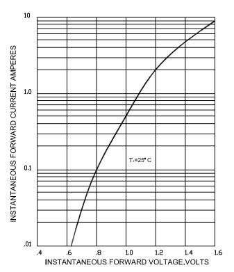
FIG.2-TYPICAL INSTANTANEOUS FORWARD CHARACTERISTICS
